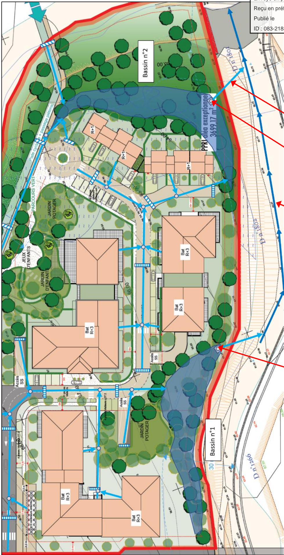
Figure 34 : Plan de masse des bassins de rétention proposé
