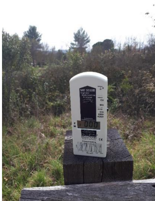
Mesure de champs électromagnétiques sur la zone du projet – Source : Photos SOWATT
